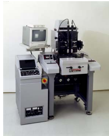
図 9 プロキシミティ露光方式のマスクアライナー Fig.9. Maskaligner of proximity exposure mode.
